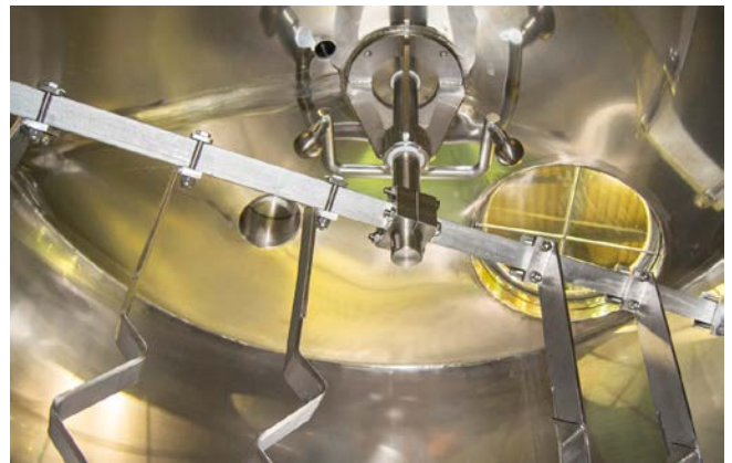
Das Innere des Behälters mit Rührwerk und Sieb. Das System mit Düsen zum Spülen der Würze. CIP-Kugeln zum Reinigen des Inneren des Behälters.
