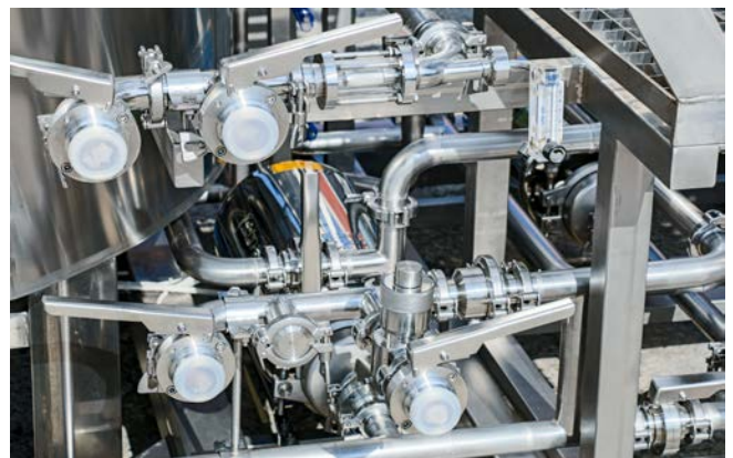
Die Ventile und das komplette System für den Transport von Flüssigkeiten sind aus hygienischen Edelstahl hoher Qualität gefertigt.
