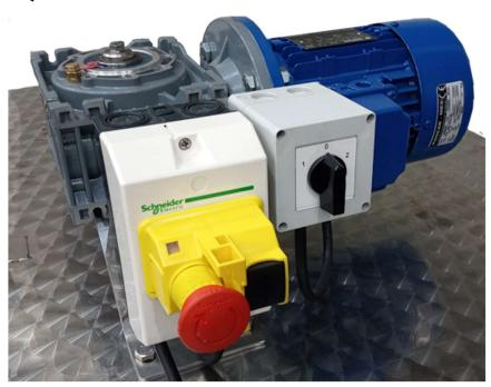
Sur la photo est un interrupteur de protection du moteur et interrupteur 1-0-2. L'interrupteur 1-0-2 est utilisé pour changer le sens de rotation.
