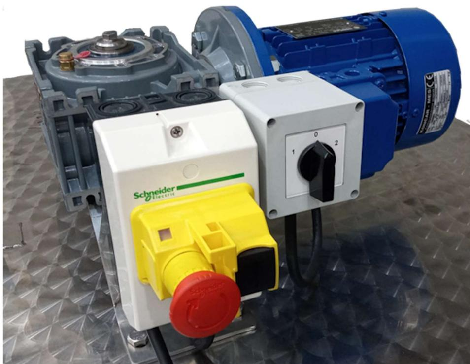
Na slici je motorska zaštitna sklopka i sklopka 1-0-2. Sklopka 1-0-2 služi za promjenu smjera vrtnje motora. Motorska zaštitna sklopka ima ugrađeno slijedeće :
