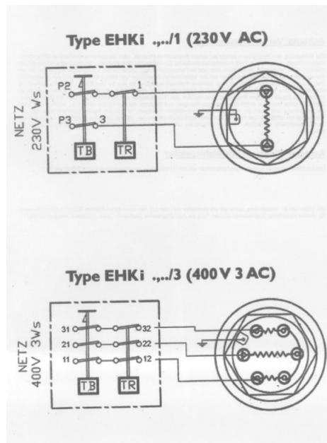
Na slici je prikazan grijać u 1-faznoj i 3-faznoj izvedbi . Ovaj grijać može opcionalno biti isporučen uz miješalicu . Ako se isporučuje , grijać se montira na donjem dijelu posude . Oko grijaća je komora koju trebate ispuniti tekućinom ( voda ili mješavina vode i glikola).
