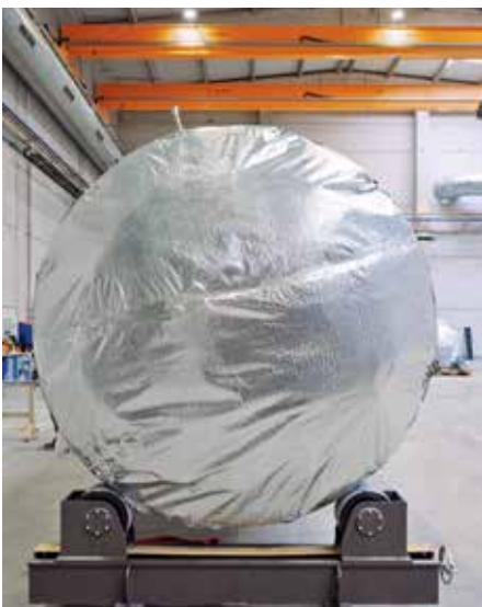
**BOČNE STIJENKE CISTERNE** izolirane su poliuretanskom pjenom dok su podnice izolirane staklenom vunom i dodatno specijalnom folijom
