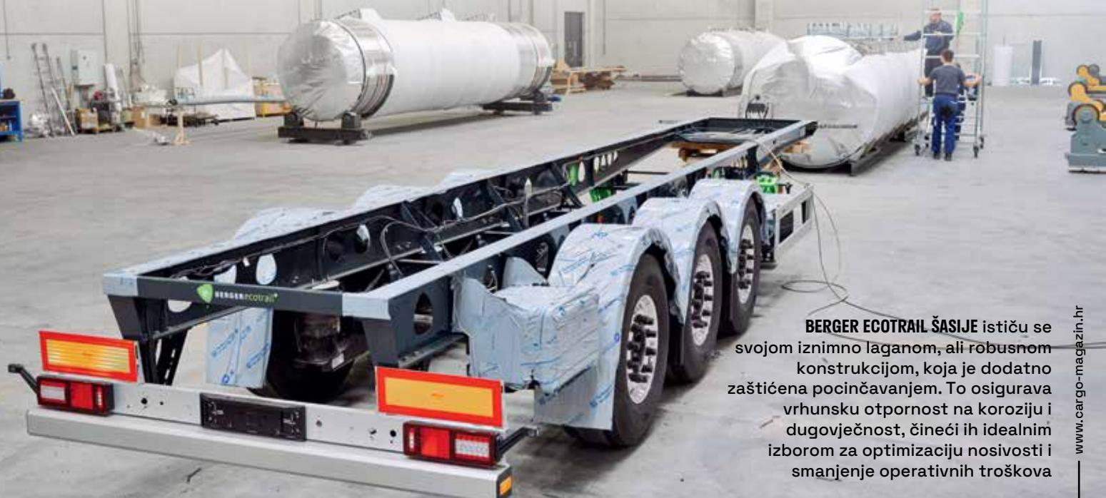
**BERGER ECOTRAIL ŠASIJE** ističu se svojom iznimno laganom, ali robustnom konstrukcijom, koja je dodatno zaštićena pocinčavanjem. To osigurava vrhunsku otpornost na koroziju i dugovječnost, čineći ih idealnim izborom za optimizaciju nosivosti i smanjenje operativnih troškova
